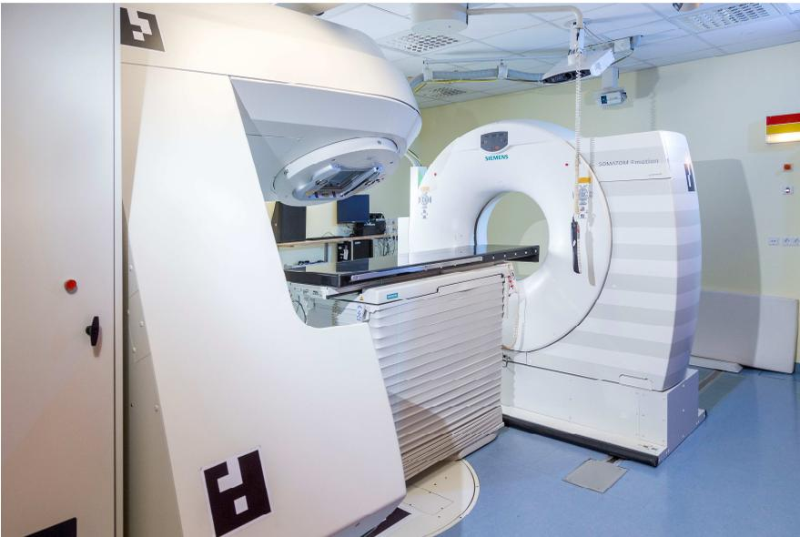
Abb. 1. Strahlentherapeutischer Behandlungsraum, ausgerüstet mit einem Linearbeschleuniger (links) und mit einem in-Room Röntgen-Computertomografen (rechts). Der bewegliche Teil des LINACs kann um  $360^\circ$  um eine horizontale Achse rotieren, so dass Patienten, die gewöhnlich in Rückenlage auf der Behandlungsliege (Mitte) positioniert sind, aus verschiedenen Richtungen bestrahlt werden können (Foto: Rainer Weisflog).
