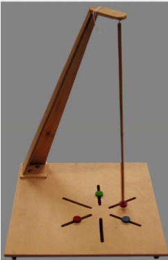
Abb. 1. Aufbau eines Magnetpendels.
