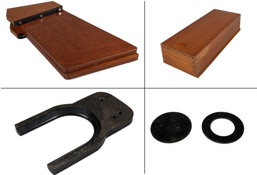
Abb. 3. Zubehör im Kasten: (oben links) Auflagebacken zum Abstützen der Hände bei der Probenpräparation (können an den Objektisch angebracht werden (siehe Abb. 1)); (oben, rechts) Einschubkästchen für Zubehör (leer); (unten, links) Hartgummigabel zum Aufschrauben des Stativoberteils zur Verwendung als Dermatoskop (siehe Abb. 6); (unten, rechts) Verschluss- und Lochblende zum Einsatz in den Mikroskoptisch.
