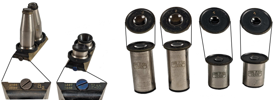
Abb. 4. Mitgelieferte Objektivpaare a2 und F=55 auf Schlitten montiert (links) und mitgelieferte Okularpaare 2 und 4 (rechts).
